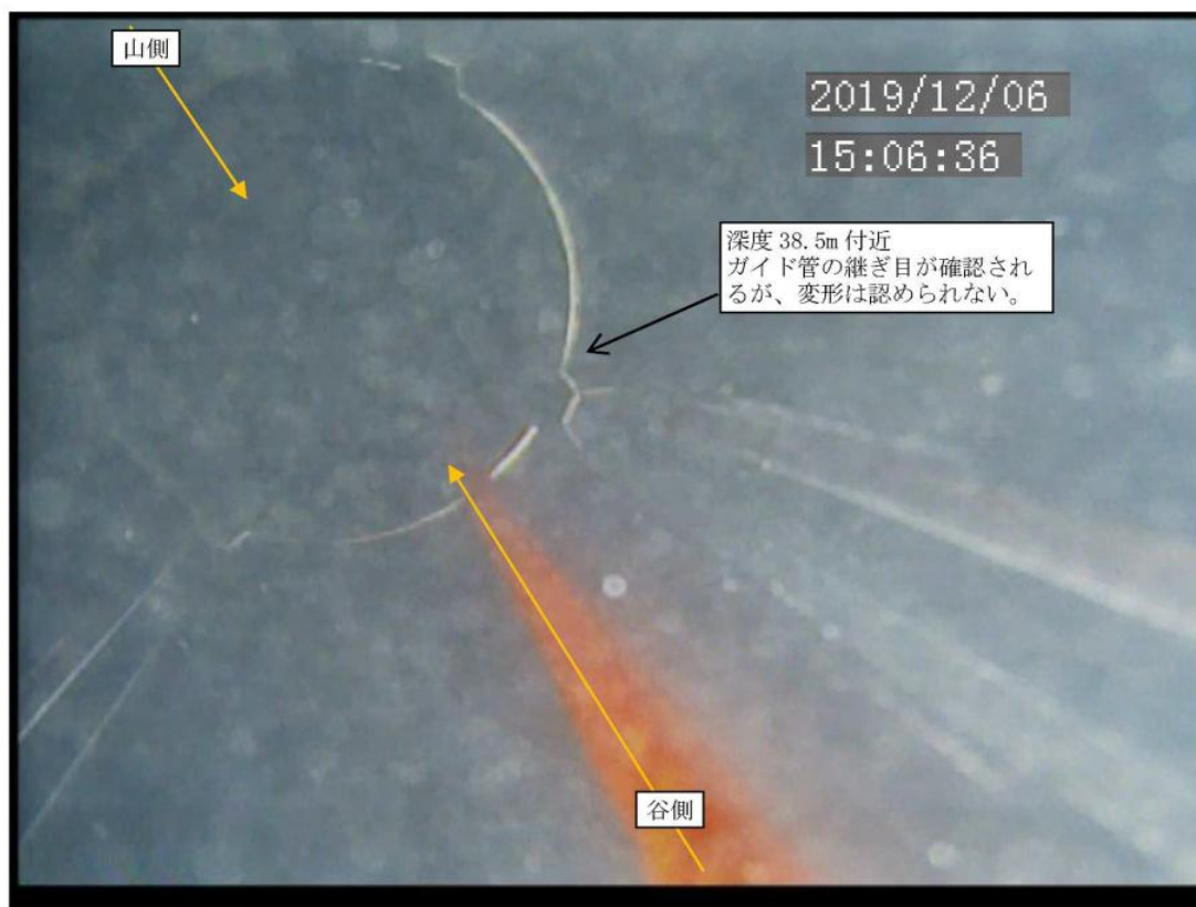
図 6.7.5 HB-291-1 深度 38.5m の孔内画像（水中の浮遊物が映る）
