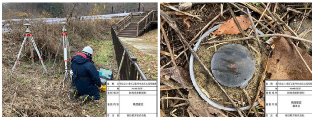
写真 3-14 GNSS 精度確認状況
