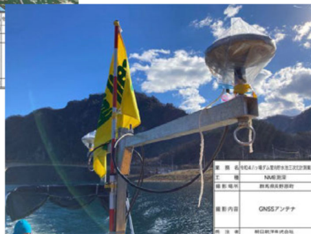
写真 3-13 測量船の艀装状況
